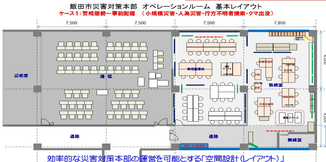
オペレーションルーム 災害への即応性を高めるため、平常時でも災害対応電話やパソコン等の機材を常置する。パーテーションを開放することで、執務スペースとして一体的に使用する。
